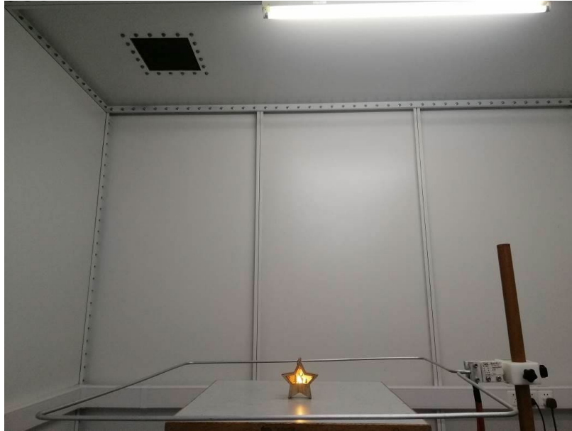
EN 61000-4-8 PFMF TEST SETUP
