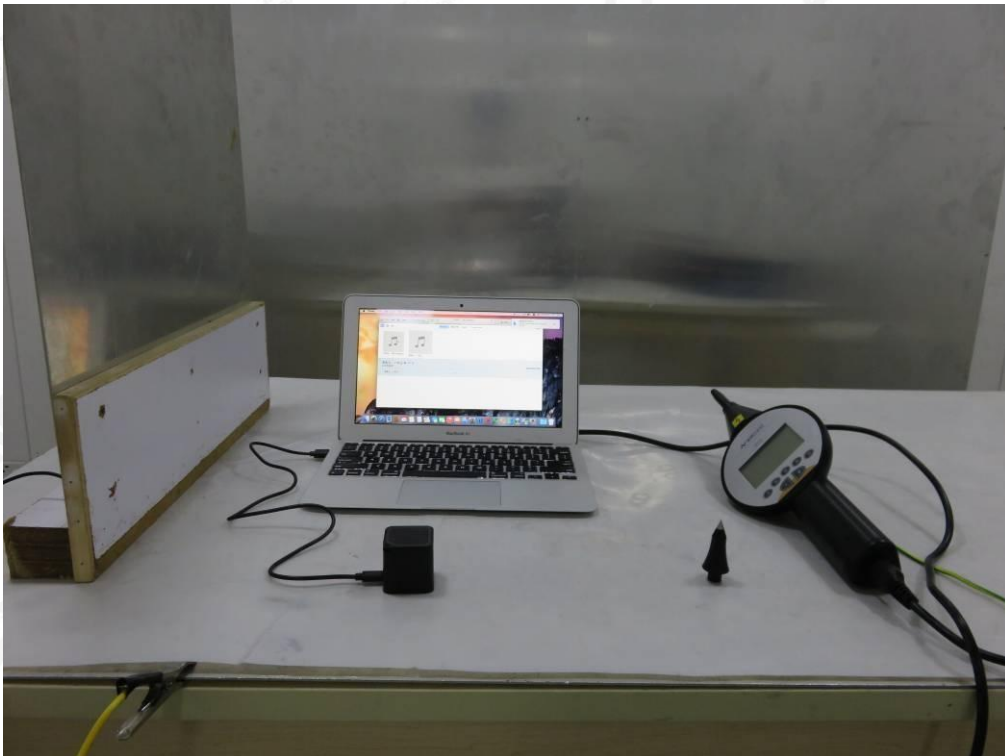
EN 61000-4-2 ESD TEST SETUP
